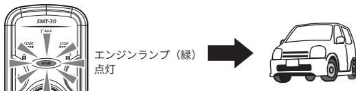
※ アンテナユニットがリモコンからの電波を受信できなかった場合は、リモコンのエンジンランプ (緑) は点灯しません。(アンサーバック音をメロディまたは、ブザーに選択されている場合は NG 音が鳴ります)
