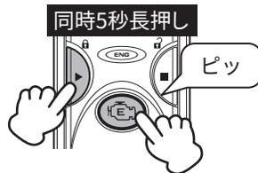
2) スタートスイッチとストップスイッチを同時に 5 秒間長押しすると、リモコンからブザー音が「ピーピッ」と鳴り周波数切替モードに入り、リモコンの LED が現在の設定で点滅します。
