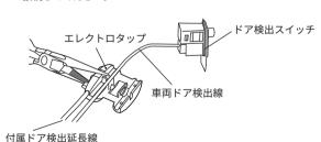
3) 各製品の取扱説明書を参照してコネクターに接続します。 14PコネクターのNo.2へ出力線を差し込み、メインユニットへ 14Pコネクターを接続します。
